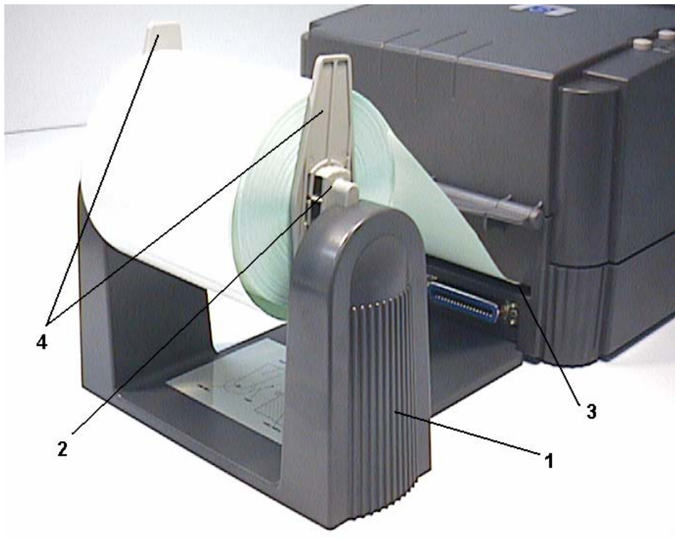
Bild 11. Anbringen der externen Etikettrollen-Halterung
