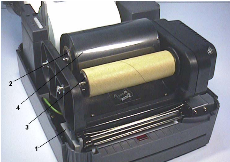
Bild 9. Einsetzen der Farbband-Zuführrolle
