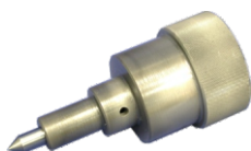
Schwere Nadelbaugruppe ø6mm für tiefe Beschriftungen Standardwinkel der Spitze: 60° Winkelvarianten: 90° / 118° Art.-Nr.: 66.62150.6S
